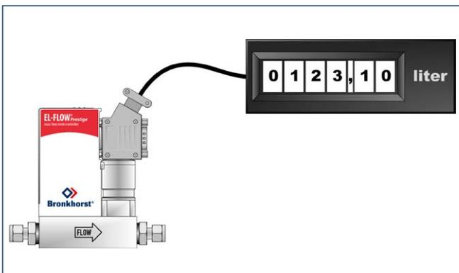
Der programmierbare Pin 5 (9-poliger Sub-D-Stecker) kann für einen vom Benutzer definierten Impulsausgang pro Menge eingestellt werden. Dieser Impuls kann direkt an Summenzähler, digitale Anzeigergeräte oder Regelinstrumente geleitet werden.
