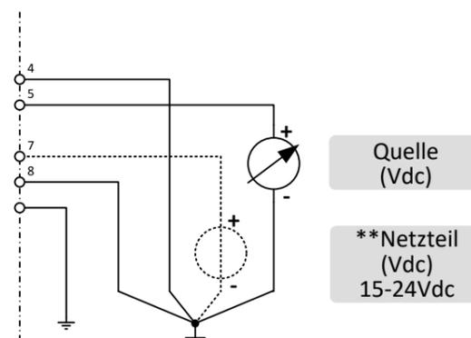
Hinweis: 0Vdc Versorgung (pin 4) und 0Vdc Sense (pin 8) sollte separat mit dem 0V Anschluss an die Stromversorgung angeschlossen werden.
