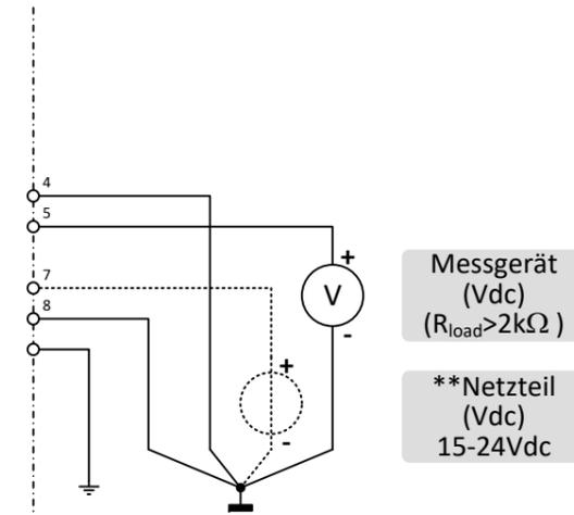
Hinweis: 0V Versorgung (Pin 4) und 0V Sense (Pin 8) sollten gesondert zum Netzteil geführt werden Am Netzteil zusammen anschließen.
