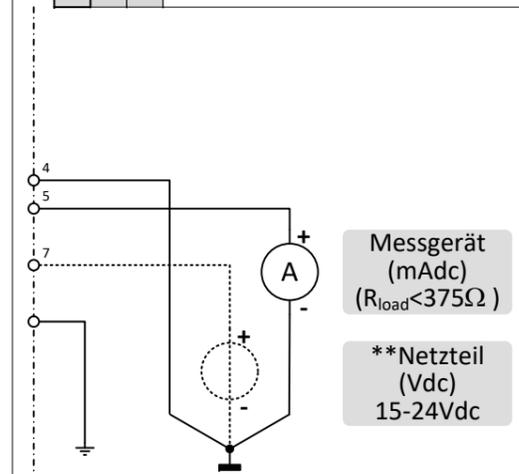
Hinweis: Im analogen Modus mit 'Messsignal mA' ist es nicht erforderlich, Pin 8 (0V sense) anzuschließen. Sollte Pin 8 im bestehenden System bereits angeschlossen sein, wird der Betrieb des Gerätes dadurch nicht beeinträchtigt.
