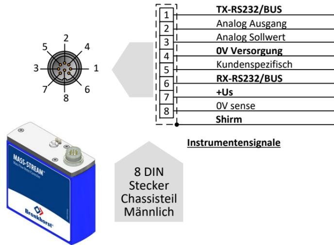
Beim Anschließen des Systems an andere Geräte müssen sie sicher sein dass, die Integrität der Abschirmung nicht beeinträchtigt wird. Verwenden Sie keine ungeschirmten Kabelanschlüsse.
