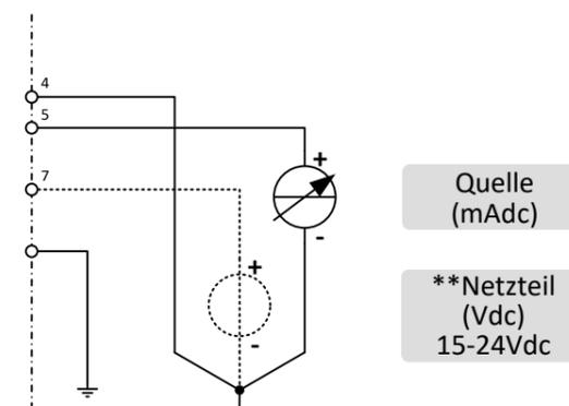
Hinweis: Im analogen Modus mit 'Messsignal mA' ist es nicht erforderlich, Pin 8 (0V sense) anzuschließen. Die Funktionsweise des Gerätes wird im Falle von 0Vdc Sense verbunden ist beeinträchtigt.
