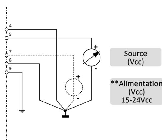
Remarque : Puissance 0Vcc (broche 4) et Détection 0Vcc (broche 8) doivent être connectés séparément à la borne 0V sur l'alimentation électrique
