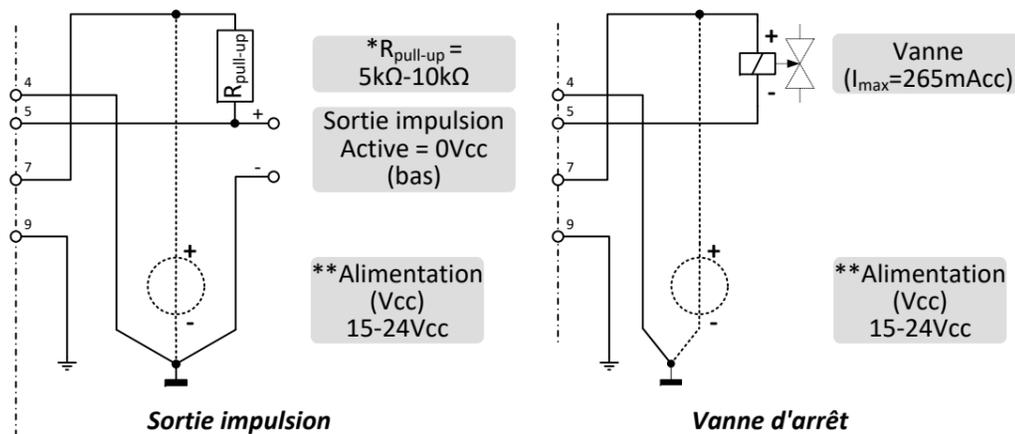
\* Utiliser Rpolarisation source (entre 5kΩ et 10 kΩ) pour produire 15-24Vcc sur la broche 5
