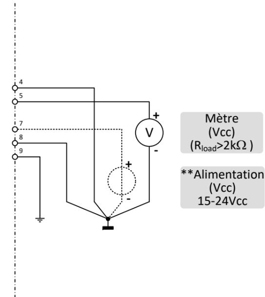
Remarque : Puissance 0Vcc (broche 4) et Détection 0Vcc (broche 8) doivent être connectés séparément à la borne 0Vcc sur l'alimentation électrique
