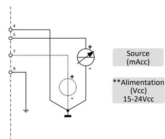
Remarque : En mode analogique avec signaux 'mA', Détection 0Vcc (broche 8) n'a pas besoin d'être connecté. L'instrument ne fonctionnera pas si Détection 0Vcc est déjà raccordé
