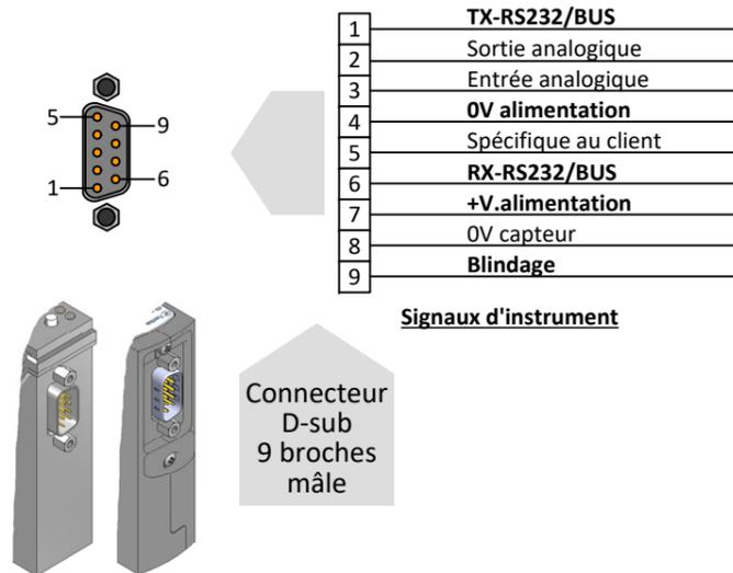
En cas de connexion du système à d'autres appareils, assurez-vous que l'intégrité du blindage n'est pas touchée. Ne pas utiliser de bornes de fil non blindées.
