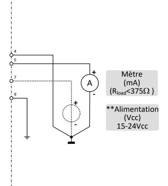
Remarque : En mode analogique avec signaux 'mA', Détection 0Vcc (broche 8) n'a pas besoin d'être connecté. Le fonctionnement de l'instrument ne sera pas affecté si Détection 0Vcc est déjà raccordé
