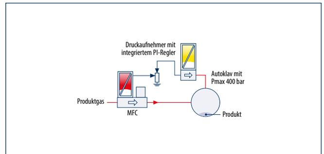
Oft wird eine Durchflussregelung mit einer Regelung des Reaktordruckes kombiniert, z.B. über einen EL-PRESS Vordruckregler, oder wie abgebildet, einem EL-PRESS Druckmesser mit integriertem PI-Regler. Typische Anwendungen: Hochdruck-Hydrieranlagen und Autoklavenprozesse unter Einsatz eines PN400 Massendurchflussreglers mit Vary-P-Regelventil.
